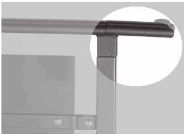
Foto 3: Particolare angolo corrimano in tubo sagomato mm. 50x25 saldato a 45° mm. 50x50
