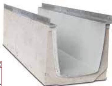
Il canale è realizzato in calcestruzzo armato e vibrato ad alta resistenza, con profili in acciaio zincato a caldo per il contenimento delle griglie e con la parte interna rivestita in materiale plastico (pp) per un bassissimo grado di scabrezza.
