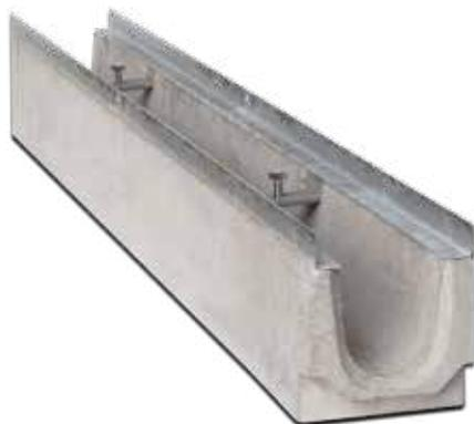
Il canale è realizzato in calcestruzzo 425 armato e vibrato ad alta resistenza e con profili in acciaio zincato a caldo per il contenimento delle griglie.
