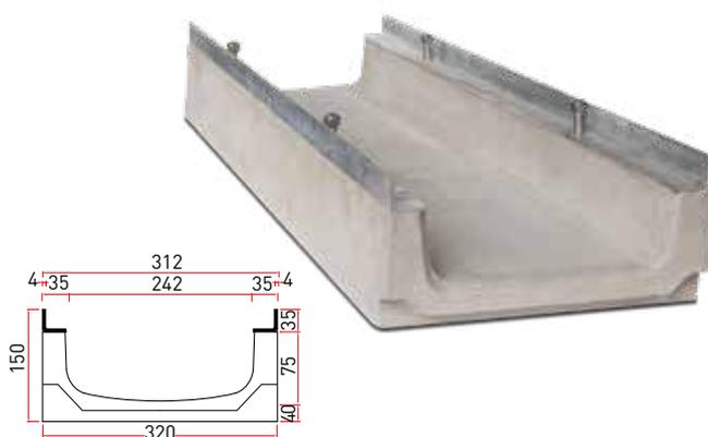
Il canale è realizzato in calcestruzzo 425 armato e vibrato ad alta resistenza e con profili in acciaio zincato a caldo per il contenimento delle griglie.
