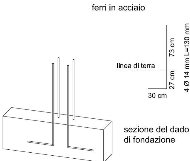
Posizionare l'armatura per la colonna e fissarla ai ferri di chiamata con del filo di ferro.
