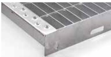
I gradini zincati a caldo sono realizzati con piatto portante e di bordatura mm 25x2 e con tondino di collegamento diam. mm 5. Sono disponibili anche i pianerottoli con spigolo rompivisuale.
