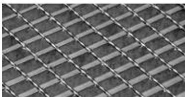
Le griglie zincate a caldo sono realizzate con piatto portante e di bordatura mm 25x2 e con quadro ritorto di collegamento mm 5x5. Sono disponibili anche nella versione "pesante", cioè con piatto portante e di bordatura mm 40x3 e con quadro ritorto di collegamento mm 5x5. I telai a "L" sono realizzati in lamiera zincata sp. 15/10
