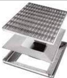
Le griglie zincate a caldo sifonate sono realizzate con piatto portante e di bordatura mm 25x2 e con piatto di collegamento mm 10x2. Sono disponibili sia nella versione M.34x38 sia nella M.33x11. I telai a "L" sono realizzati in lamiera zincata a caldo. I sifoni sono realizzati in materiale plastico.
