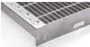
I gradini zincati a caldo sono realizzati con piatto portante e di bordatura mm 25x2 e con tondino di collegamento diam. mm 5. Sono disponibili anche i pianerottoli con spigolo rompivisuale. Nella misura mm 1200 è disponibile anche il gradino con piatto portante mm 30x2.
