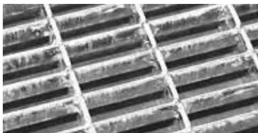
Le griglie zincate a caldo per bocche da lupo sono realizzate con piatto portante e di bordatura mm 25x2 e con piatto di collegamento mm 10x2. Sono disponibili sia CON ZANCHE DI FISSAGGIO SALDATE alla griglia (fisse) sia con TELAIO CON ZANCHE DI FISSAGGIO (estraibili). I telai a "L" sono realizzati in lamiera zincata a caldo.
