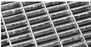
Le griglie zincate a caldo sono realizzate con piatto portante e di bordatura mm 25x2 e con piatto di collegamento mm 10x2. I telai a "L" sono realizzati in lamiera zincata sp. 15/10.
