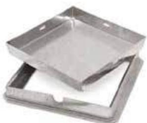
I sigilli pesanti zincati a caldo sono realizzati in lamiera sp. 20/10. Il telaio a "T" è realizzato in lamiera sp. 25/10 zincato a caldo. Su due lati sono state ricavate delle asole per l'inserimento del gancio per un veloce sollevamento dall'interno.
