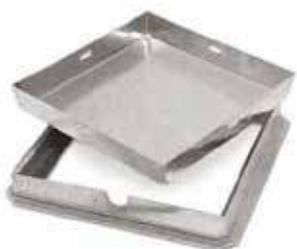
I sigilli pesanti zincati a caldo sono realizzati in lamiera sp. 20/10. Anche il telaio a "T" è realizzato in lamiera sp. 20/10 zincato a caldo. Su due lati sono state ricavate delle asole per l'inserimento del gancio per un veloce sollevamento dell'interno.
