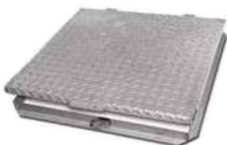
I coperchi per cisterna zincati a caldo sono realizzati in lamiera bugnata sp. 25/10, sono rinforzati nella parte inferiore e sono completi di telaio a "L" pesante zincato a caldo. L'altezza totale (coperchio + telaio) è di 42,5 mm.
