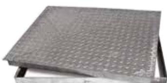
I chiusini piani zincati a caldo sono realizzati in lamiera bugnata sp. 25/10, sono rinforzati nella parte inferiore e sono completi di telaio a "L" in lamiera zincata sp. 15/10. L'altezza totale (chiusino + telaio) è di 50 mm.
